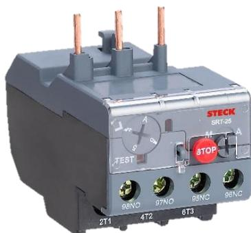
Indispensable en la instalación de equipamientos y maquinarias. El dispositivo Relé Steck detecta anomalías de la corriente eléctrica y suspende inmediatamente el funcionamiento del motor sin dañarlo, aumentando su tiempo de vida útil. Aplicado en circuitos AC 50/60 Hz, posee tensión de trabajo nominal hasta 690V con corriente de 0,1A a 630A
