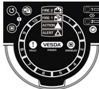
Al abrir la puerta de acceso para mantenimiento, el usuario puede activar las funciones RESTAURAR, DESACTIVAR, Prueba de incendio, AutoLearn e Instant Fault Finder (Localizador Instantáneo de Averías). Cuando se activa la función Instant Fault Finder, la pantalla circular se transforma en un indicador de averías cuyos números corresponden a las averías que se enumeran a continuación.
