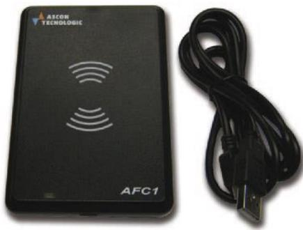
Para configuração via NFC, não é necessário energizar o instrumento, mas é suficiente encostar a parte frontal do instrumento onde o display está localizado na superfície do dispositivo AFC1 (que é alimentado diretamente da porta USB conectada ao PC) ou na parte do smartphone no que é a interface NFC (para isso consulte o manual do usuário do smartphone).
