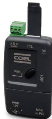
Este dispositivo A01 é útil principalmente para a programação serial dos instrumentos que devem ter a mesma configuração de parâmetros ou para manter uma cópia da programação do instrumento e permitir sua rápida retransmissão.
